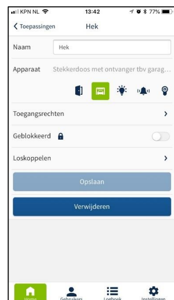
5.3 Nadat apparaat gekoppeld is ► opslaan. Toegangsrechten kunnen later aan gebruiker worden gekoppeld
