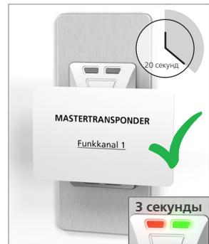
3. В течение 20 секунд необходимо еще раз поднести и удерживать мастер-карту, начиная с шага 1, параллельно к бесконтактному считывателю, а затем убрать ее. Дополнительно приблизительно на 3 секунды загорится зеленый светодиод. После этого оба светодиода погаснут. Таким образом, процесс удаления пользовательского транспондера успешно завершен.
