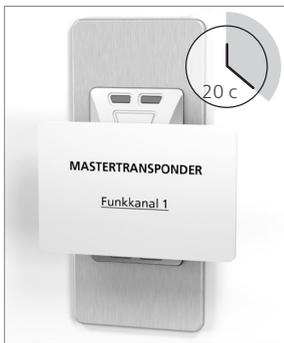
1. Удерживать **выбранную мастер-карту в течение примерно 20 секунд параллельно перед бесконтактным считывателем**, таким образом будут удалены все пользовательские транспондеры из каналов 1 и 2.
