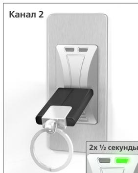
Если пользовательский транспондер был ранее запрограммирован для канала 2, зеленый светодиод загорится на 2 раза на 1/2 секунды. Таким образом, можно в любой момент определить, на какой канал запрограммирован пользовательский транспондер.
