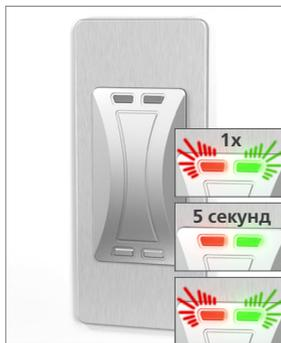
2. Светодиодная индикация: В начале этих 20 секунд сперва красный и зеленый светодиода мигнут один раз, а затем загораются на 5 секунд. Далее они будут попеременно мигать сначала медленно, затем очень быстро. Начался процесс удаления. Можно убрать карту от бесконтактного считывателя.
