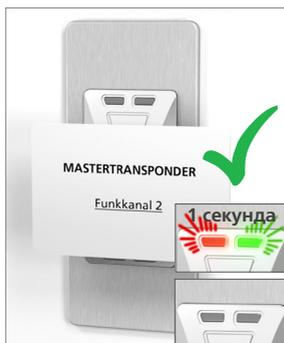
1. **Кратковременно приложить мастер-карту «Funkkanal 1» к бесконтактному считывателю.** Если считыватель распознал карту, оба светодиода погаснут на 1 секунду, а затем снова загорятся.
