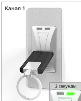
Если пользовательский транспондер был ранее запрограммирован в бесконтактном считывателе для канала 1, зеленый светодиод загорится на 2 секунды и погаснет. В течение этого времени бесконтактный считыватель автоматически отправляет сигнал по каналу 1.
