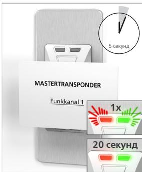
1. Удерживать **выбранную мастер-карту примерно 5 секунд параллельно возле бесконтактного считывателя**, затем убрать ее. Красный и зеленый светодиоды одновременно загорятся один раз, а затем оба будут гореть на протяжении 20 секунд.
