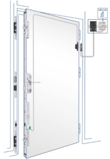
Steuerung und Netzteil zur Hutschienen-Montage im Schaltschrank
